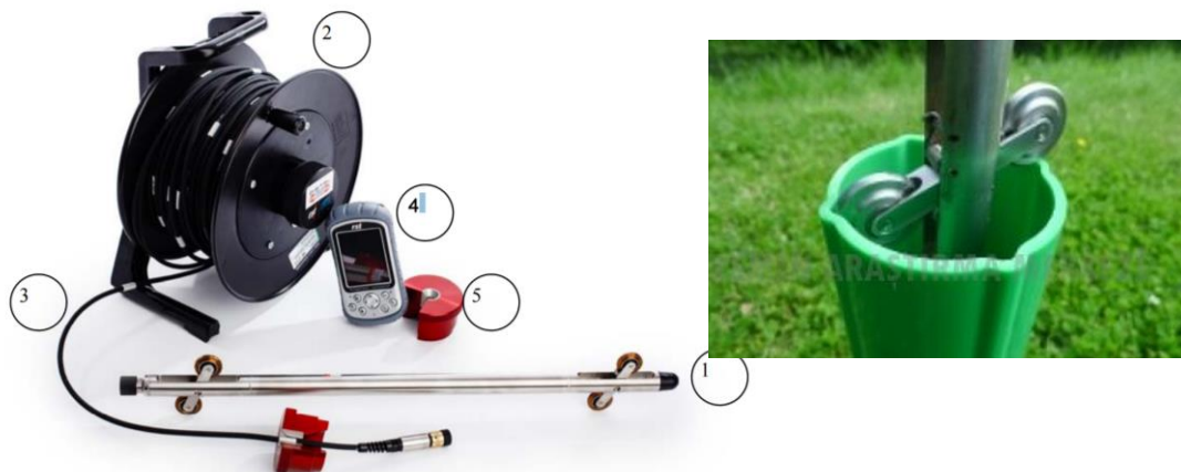
Слика 2.3: Дјелови инклинометра и приказ цијеви и индикатора (1)
